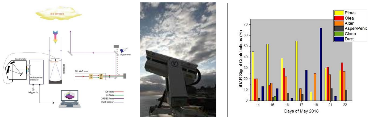
Σχήμα 9. Αριστερά: Αρχή λειτουργίας συστήματος lidar για την καταγραφή της γύρης σε 3 διαστάσεις (Richardson et al., 2019). Μέσον: Σύστημα lidar 3-διάστατης σάρωσης (Raymetrics A.E.). Δεξιά: Ποιοτική/ποσοτική καταγραφή διαφόρων ειδών γύρης (πεύκου, ελιάς κυπαρισσιού, γρασιδιού, κλπ.) και ερημικής σκόνης (Richardson et al., 2019).
