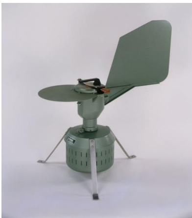
Σχήμα 7. Παράδειγμα οργάνου καταμέτρησης γύρης (γυρεοπαγίδα)
